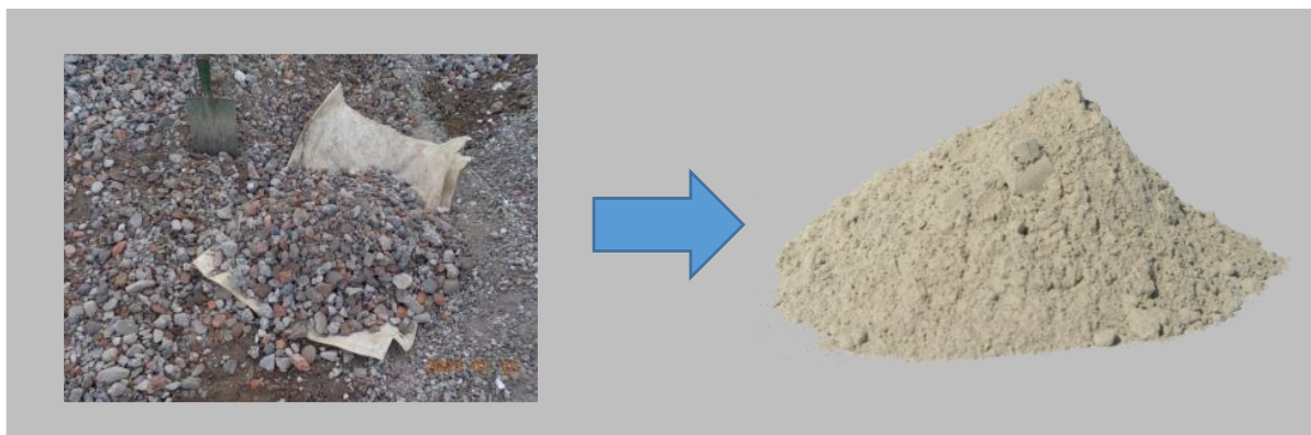
Mikronisieren des anfallenden Bauschutts
